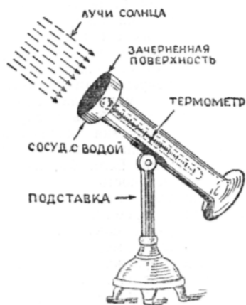
Актинометр — прибор для определения количества тепла, посылаемого Солнцем на Землю.
